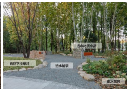
改造后的鸟悦园一角：在梳理现状林木的基础上，因地制宜地开辟了一个自然休憩空间。场地内大量采用生态材料，充分利用原有地形地貌并结合透水铺装、雨水花园等海绵设施的打造，重塑了一个可以实现雨水自然迁移、乐享自然的趣味空间。
